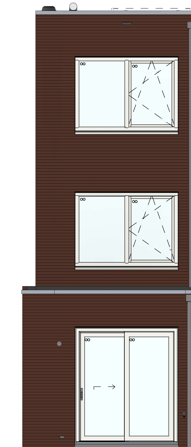
AB3912 - Aanbouw aan de achterzijde woning, over de volledige breedte, lang 1200 mm
